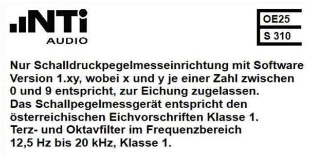
Abbildung 1: Typenschild, wird ergänzt durch einen Aufkleber mit Bauartbezeichnung und Seriennummern des Schallpegelmessers, des Vorverstärkers und des Mikrofons.
